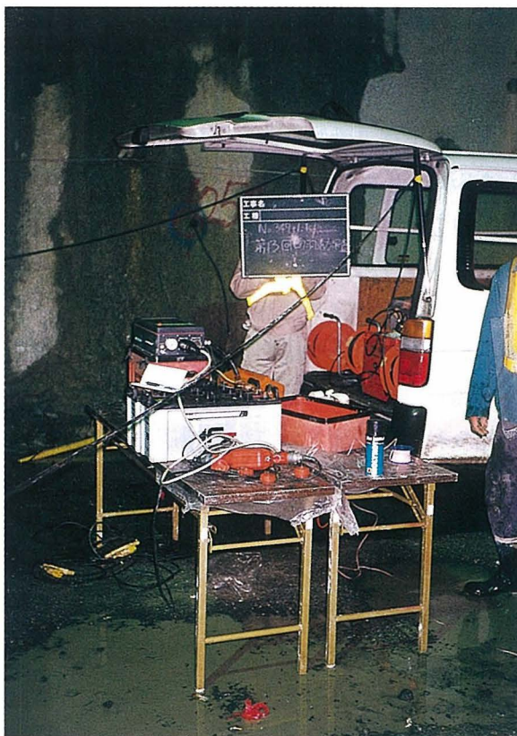
図-2 TSP・トンネルHSP測定機一式
