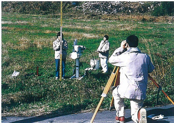
写真-2 原位置での試験風景1 (水準測量)
